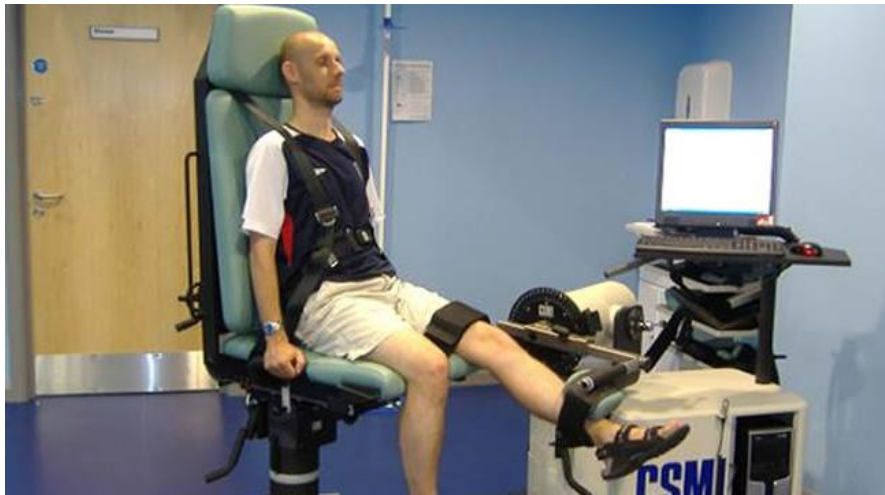
รูปที่ 7.24 เครื่องมือสร้างการหดตัวของกล้ามเนื้อโดยที่ความเร็วการหดตัวคงที่ (ที่มา University of Central Lancashire, 2014)
